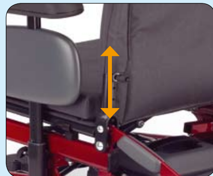
Respaldo desmontable, regulable en altura: 43 cm, 46 cm y 49 cm (sin necesidad de herramientas)
