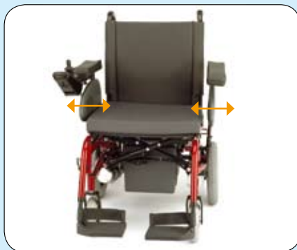
La anchura total del espacio de asiento se puede ampliar hasta en 6 cm (3 cm a cada lado) mediante los reposabrazos.
