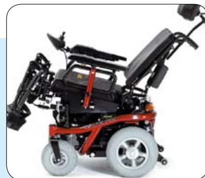
Ajuste manual de la basculación y de la altura del asiento
