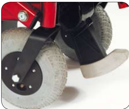
Sube bordillos capaz de subir escalones de hasta 10 cm.
