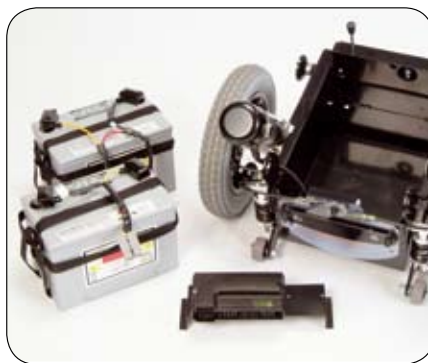
Baterías de gel de 60 Amph
