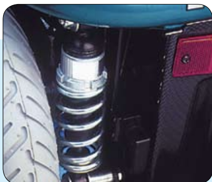
Suspensión ajustable de las ruedas traseras
