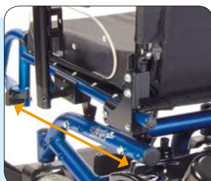
Profundidad de asiento y centro de gravedad ajustables
